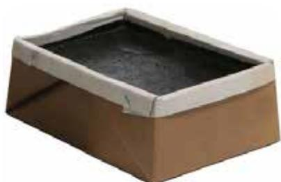
MASTIC 3 TP è un mastice bituminoso da colare a caldo, composto da un mix di gomma sintetica, bitume e resine tekizzanti. MASTIC 3 TP è stato studiato appositamente per la realizzazione di giunti tampone e la sigillatura di sottoservizi. MASTIC 3 TP soddisfa i principali requisiti della normativa EN 14188-1 Class N2.
